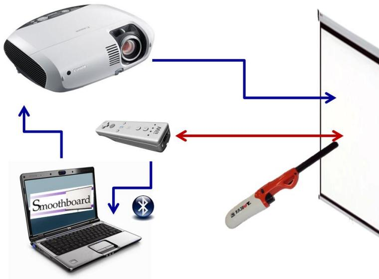
Ilustración 91: Sistema que conforma la superficie interactiva
