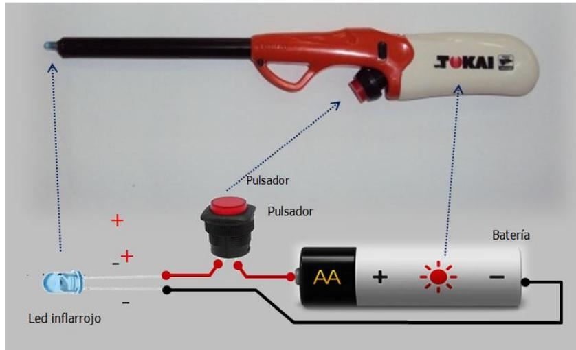
Ilustración 87: Diagrama de construcción del lápiz infrarrojo
